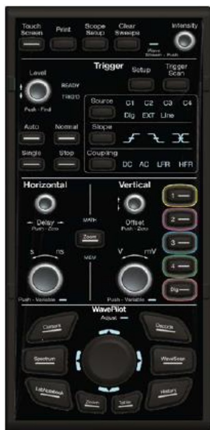
Рис. 2. Передняя панель WaveRunner LeCroy WaveRunner 640Zi.
