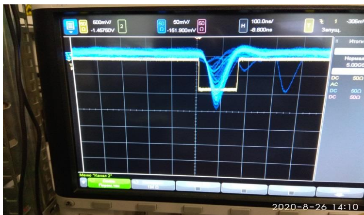
Рис.19. Сигналы с электронного тракта установки, подготовленные для зарядового оцифровщика (аналоговый и цифровой - Gate) Далее в блоке VMI информация оцифровывается и считывается в персональный компьютер для обработки и представления.
