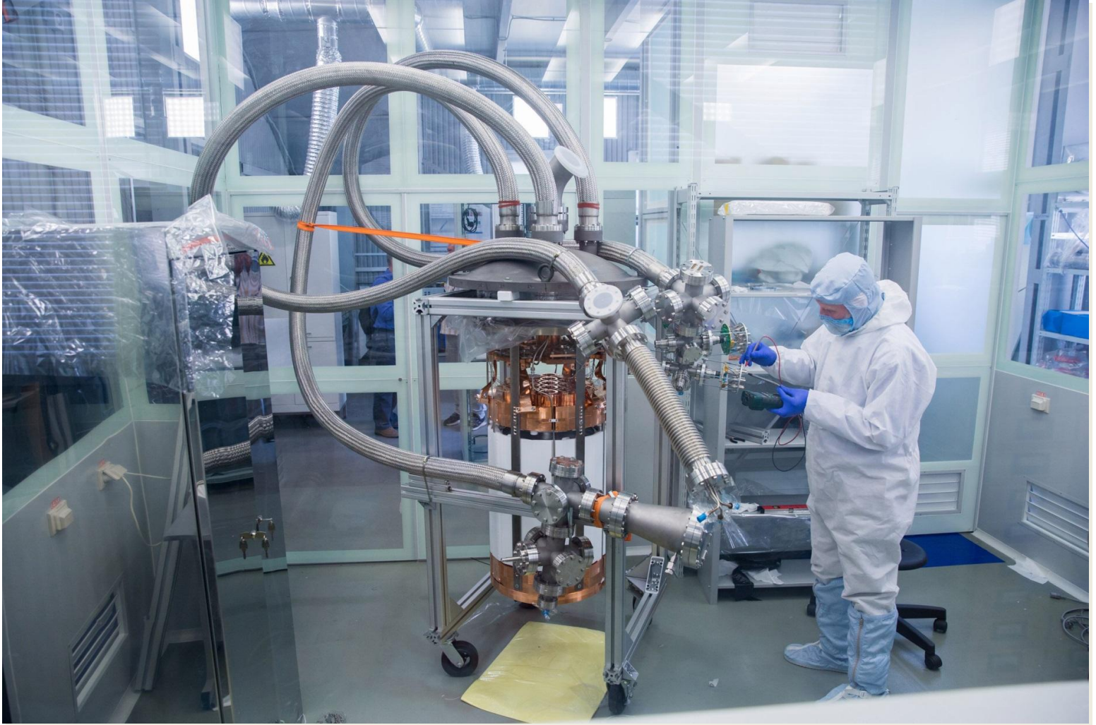
Монтаж внутренней структуры детектора РЭД-100 в чистой комнате ISO5 класса
