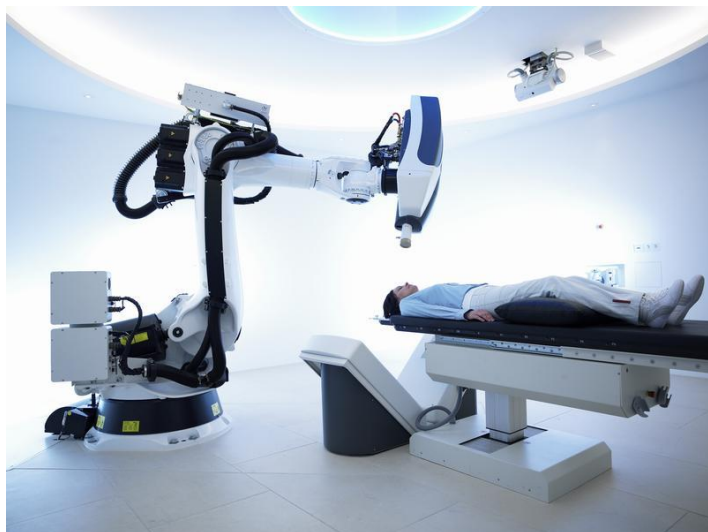
Радиохирургическая система «Кибернож», использующая рентгеновское излучение
