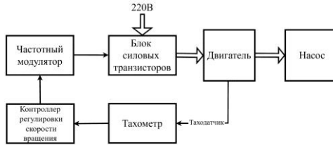
Рис. 2. Схема управления частотой вращения асинхронного электродвигателя Atlant 1BA6745-2-0025-01.
