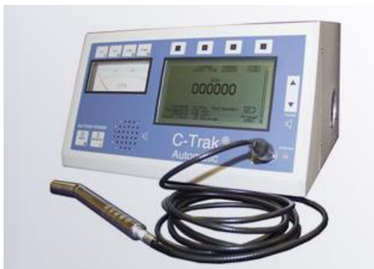
Рис. 2. Внешний вид гамма-зонда C-Trak Automatic [11]
